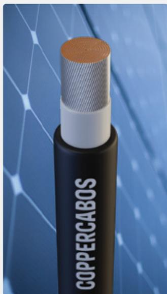
**Condutor:** Cabo flexível de cobre estanhado, têmpera mole e classe 5, atendendo à norma NBR NM 280.
